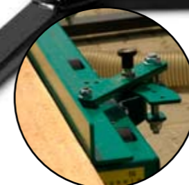
Положение направляющей планки регулируется
