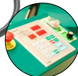
Электронная линейка SW Networks Увеличивает производительность и точность пиления за счет быстрой установки пилы в определенное положение для получения доски заданной ширины.
