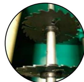
Циркулярные пилы Две циркулярные пилы. Положение одной зафиксировано, а вторая автоматически перемещается на валу.
