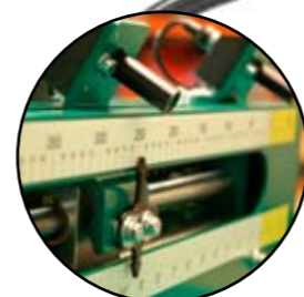
Автоматическая установка ширины пропила
